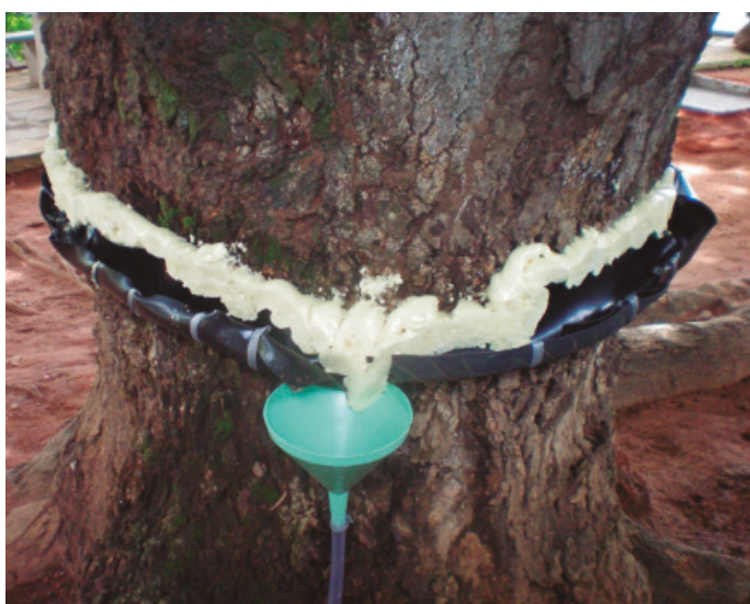
Figura 1 – Imagem de uma das estruturas para captação do escoamento pelo tronco.
