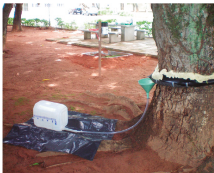
Figura 1 – Imagem de uma das estruturas para captação do escoamento pelo tronco.
