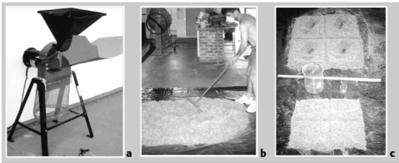
Figura 4 – Triturador forrageiro TRAPP-TRF70, adaptado para reduzir perda de biomassa (a). Homogeneização do material triturado (b). Amostragem por quarteamentos sucessivos (c)
