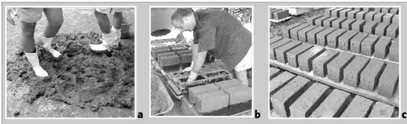
Figura 5 – Amassamento do barro com os pés (a); moldagem (b) e secagem dos tijolos (c)
