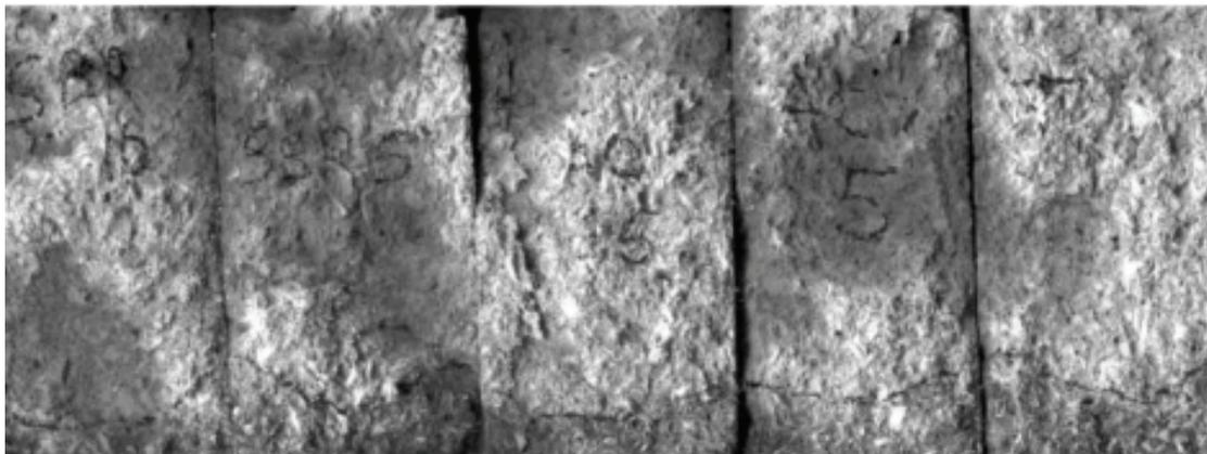
Figura 7 – Aspecto dos corpos-de-prova em função do tratamento; da esquerda para a direita os corpos-de-prova seguem a seguinte ordem de tratamento: SBR10, SBR5, AC15, AC5, T
