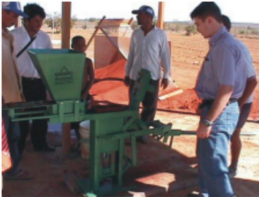
Ilustração 2 – Máquina para fabricação de tijolos de solo-cimento em João Dourado – BA
