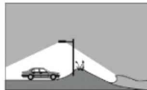
Figura 3 – Controle do fluxo luminoso para proteção das tartarugas marinhas
