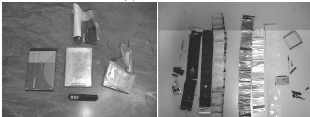
Figura 2 - Componentes externos e internos que constituem as baterias de íons de lítio
