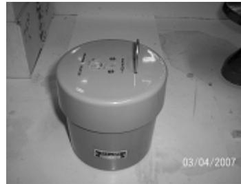
Figura 1b. Calorímetro.
