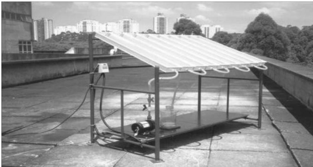
Figura 2 - Reator Solar parabólico.
