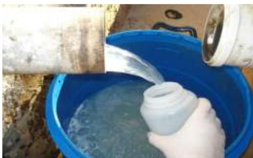
Figura 3. Ponto de coleta de efluente do laticínio para realização de análises físicas, químicas e biológicas.
