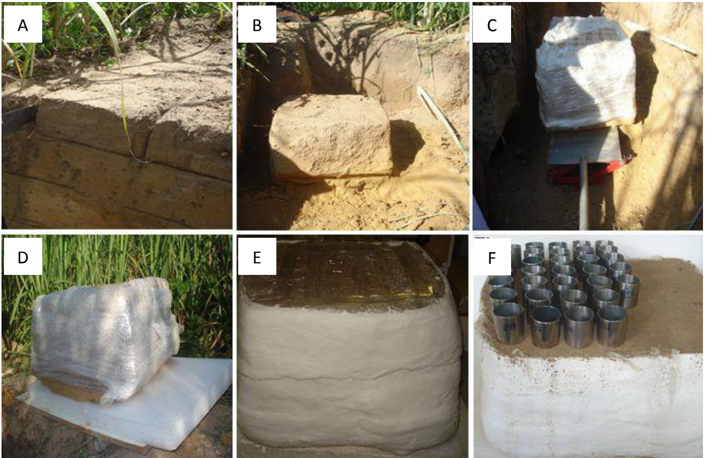
Figura 1 – Sequência da amostragem dos solos: separação do bloco do perfil (A e B); acondicionamento do bloco (C, D e E); e inserção dos anéis volumétricos (F).
