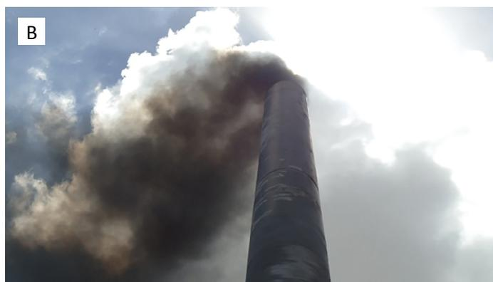
Figura 2 – Emissão de material particulado e de gases para a atmosfera durante o teste de queima com dormentes.
