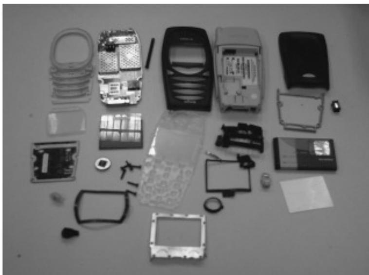
Figura 2 - Celular Desmontado
